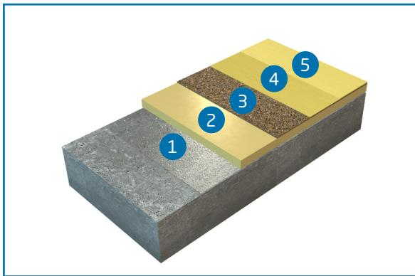
Рис. 1. Наливное колерованное покрытие, загруженное песком
