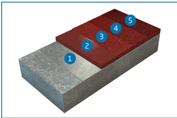
Рис. 3. Наливное колерованное покрытие, загруженное цветным песком
